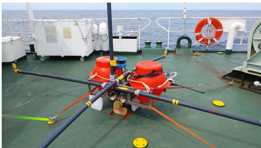
図3（続き） 圧力計付き OBEM (OBEMP)（撮影者：大島）
