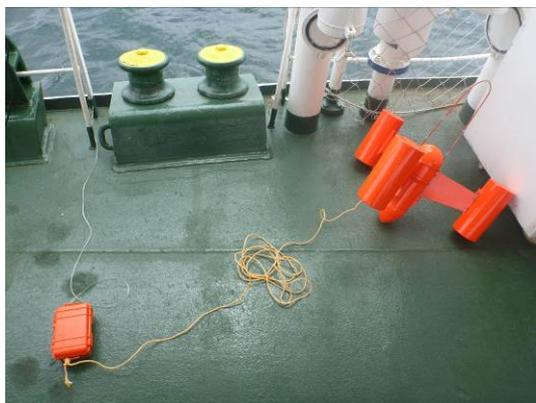
図3 投げ込み式波浪計測ブイ
