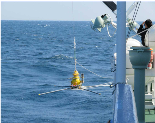
海底電位磁力計の投下・設置
