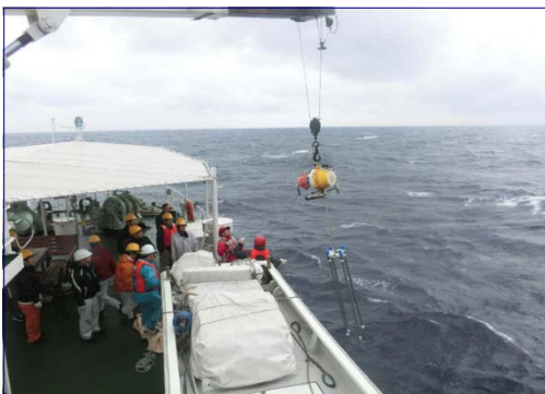
海底電位磁力計の洋上回収
