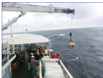
海底電位磁力計の回収
