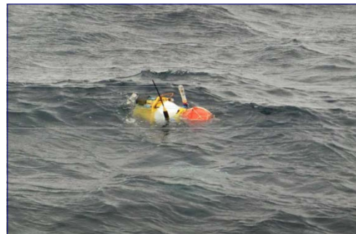
海底から浮上した海底電位磁力計
