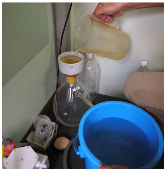
海水サンプルに含まれる有機フッ素化合物のフィルターへの吸着
