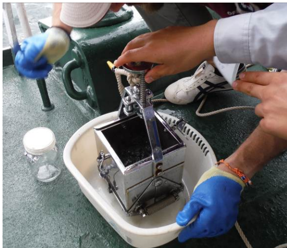
採泥器による底質サンプルの採取
