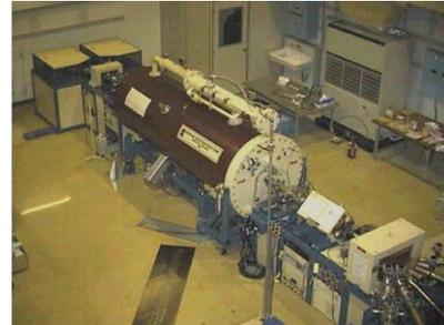
放射線とは高エネルギー（高速）の原子や電子、そして光のことです。それはうまく制御して使えば非常に貴重なもので、多くの特異な用途があります。原子をイオンにして任意のエネルギーに加速する装置が加速器です。本学の「タンデム静電加速器」で特異な用途の一端を見て下さい。
