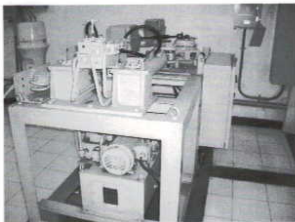
写真. 1 3 実習用操舵装置
