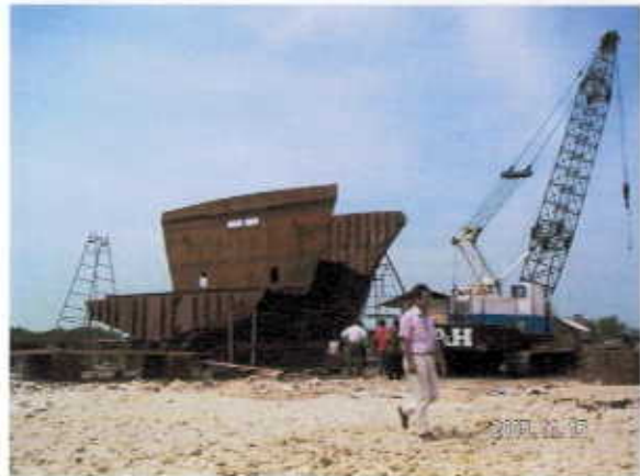
写真. 4 建造中のタグボート（船尾側）
