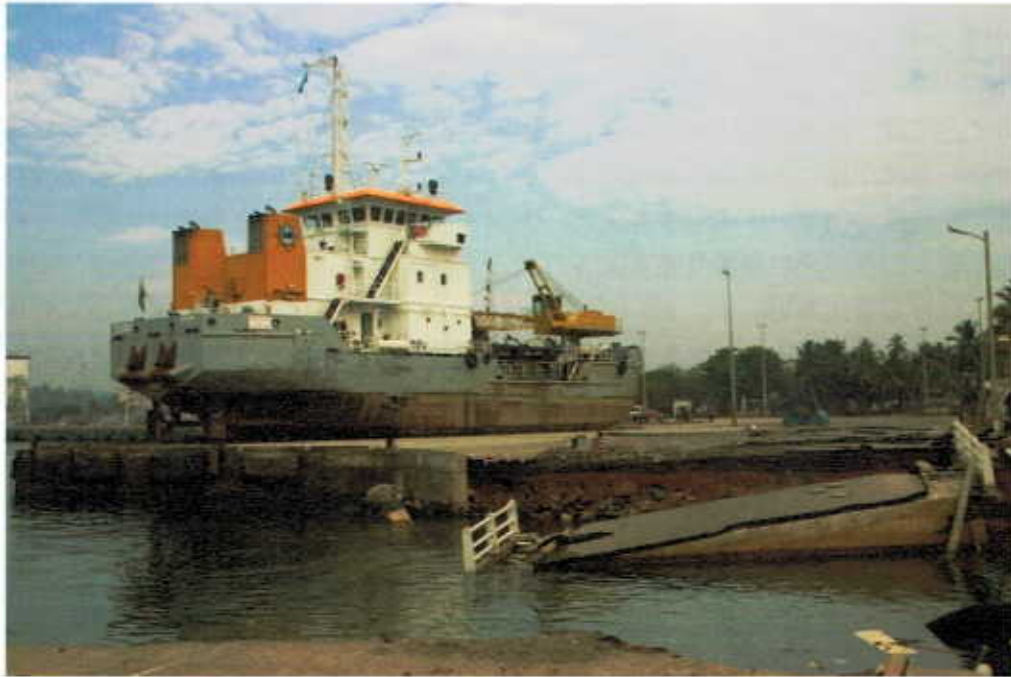
岸壁の上に押し上げられた浚渫船 Diyakawa 号
