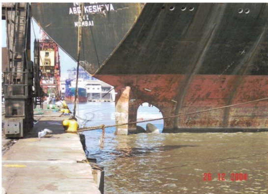
係留索がきれた大型商船の船尾部がガントリークレーンに接触
