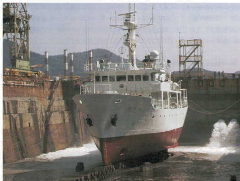
図 15 入渠工事完了、浮上前の深江丸
